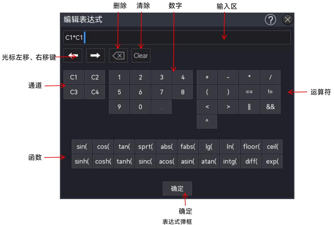
编辑表达式弹框中，触摸选择内容并编辑正确的表达式。
