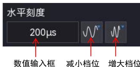
MSO2000X/3000X 系列示波器支持水平微调，您可以通过按下前面板右侧的 水平 SCALE 旋钮切换“粗调”和“微调”。
