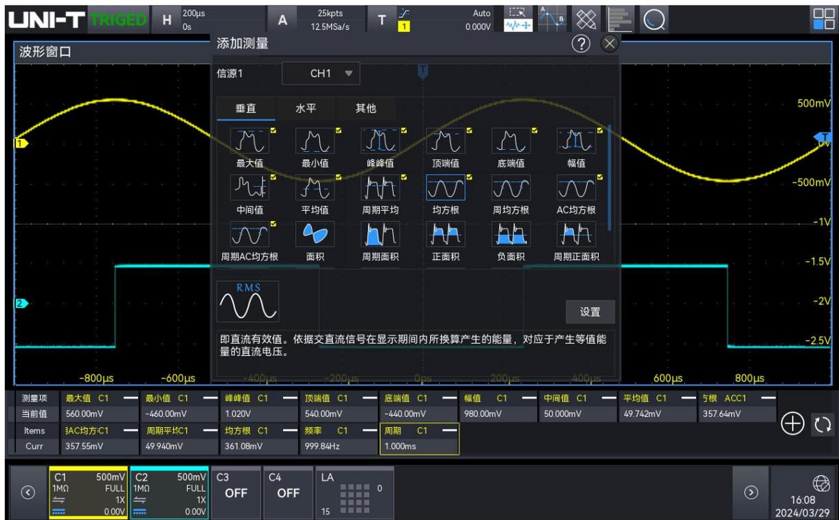
参数测量显示在伏格信息框上方，显示测量项、当前值两项。参数测量中，默认将计数器、电压表显示在最左侧，自定义参数显示在其后。参数测量最多支持设置 27 个参数。
