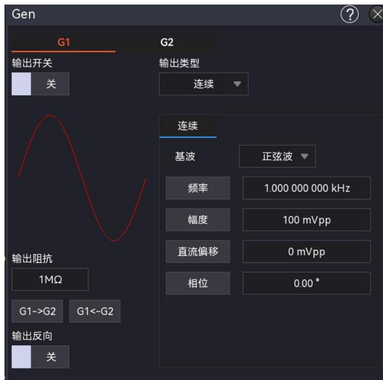
示波器支持两个 Gen 信号输出：G1、G2。您可以在“Gen”弹框中，点击 G1、G2 页签进行选择，选中的页签会高亮显示。本文档以 G1 为例详细介绍 Gen。
