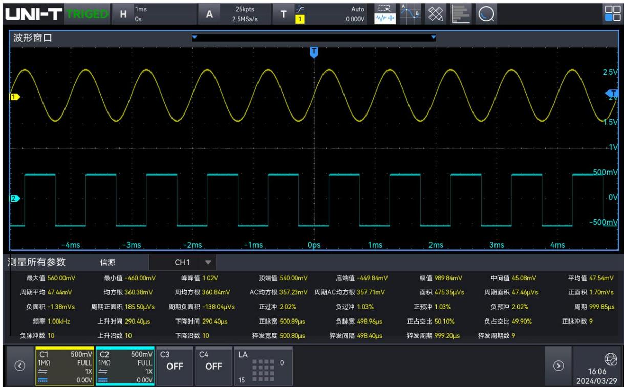
参数快照弹框可设置对不同源进行测量，点击“源”下拉框，选择需要测量的源，可选择 CH1~CH4、Math1~Math4。测量结果颜色与所有源的主题颜色保持一致。
