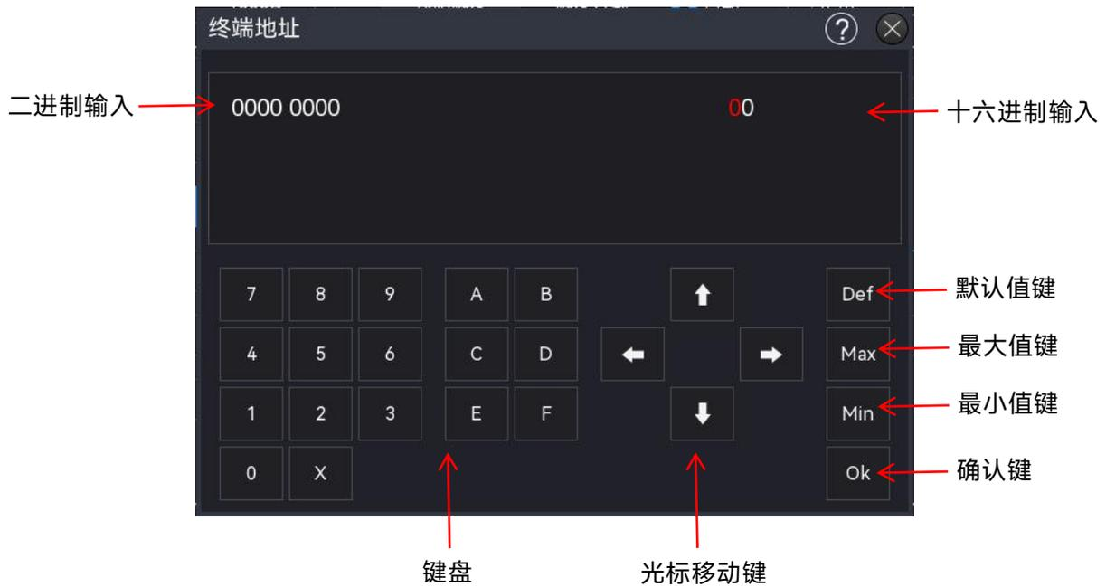
输入全部数值，按下“Ok”键后，数字键盘自动关闭，则完成参数设置。在数字键盘中，您还可以进行以下操作：
