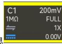
调节过程中波形显示幅度会增大或减小，同时屏幕下方的档位信息实时变化。垂直档位步进为 1-2-5，按下旋钮可使垂直档位调整方式在 粗调、微调 之间切换。
