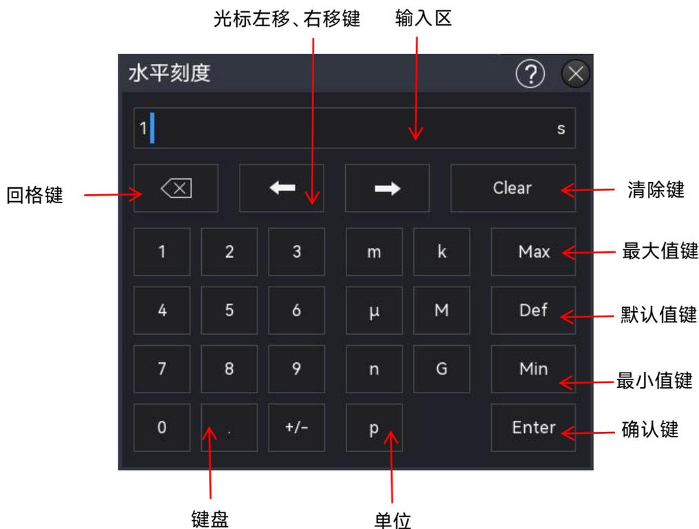
输入全部数值并选择所需的单位后，数字键盘自动关闭，则完成参数设置。另外，完成数值输入后，您也可以直接点击数字键盘中的确认键关闭数字键盘，此时参数的单位为默认单位。在数字键盘中，您还可以进行以下操作：
