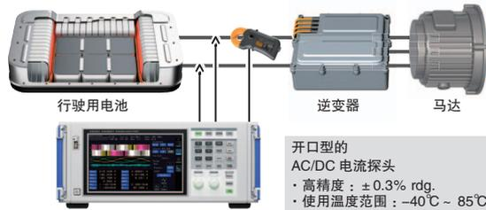
整车的模式行驶 (WLTP 模式等) 中, 以 5MHz 的采样速度准确
