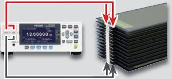
通过测量电池连接处 · 母线的电阻来确认焊接的质量。焊接不良时，连接处的电阻会变大，充放电时会发生较大热损耗。
