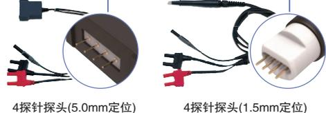
体积电阻率, 表面电阻率, 导电率的测量
