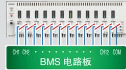
各通道串联连接最大可模拟 1000V 的电池
