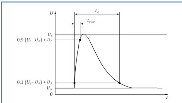
图14-没有集中负载转储抑制的测试
