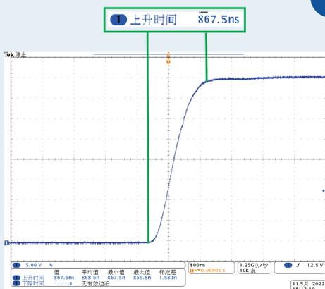
频率特性100kHz-500kHz (CV模式) 上升沿和下降沿的响应时间≤10μs。
