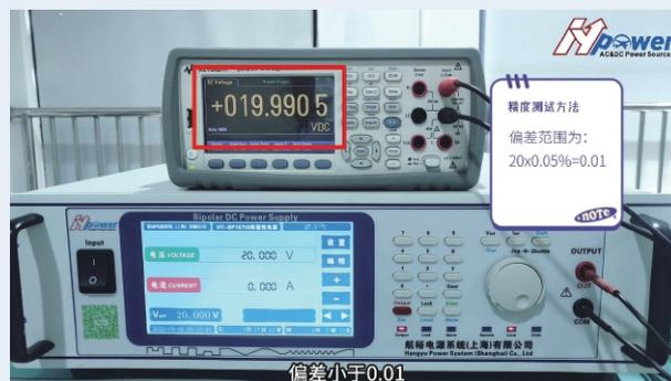
在满量程的条件下，实测20V精度，偏差小于0.01，精度达到0.05级。
