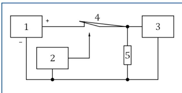
图9-12V/24V电力系统下的微中断测试装置
