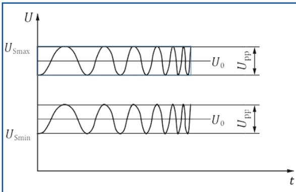
图4-发电机纹波叠加测试脉冲频率时序
